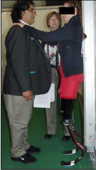
圖 2：運動員站在堅固的垂直柱前，而不是牆上，這樣可以讓假肢葉片最靠後的部分位於柱子後面。
