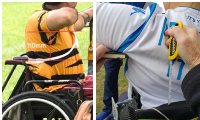
圖 20：最小腋窩距離 110 毫米
